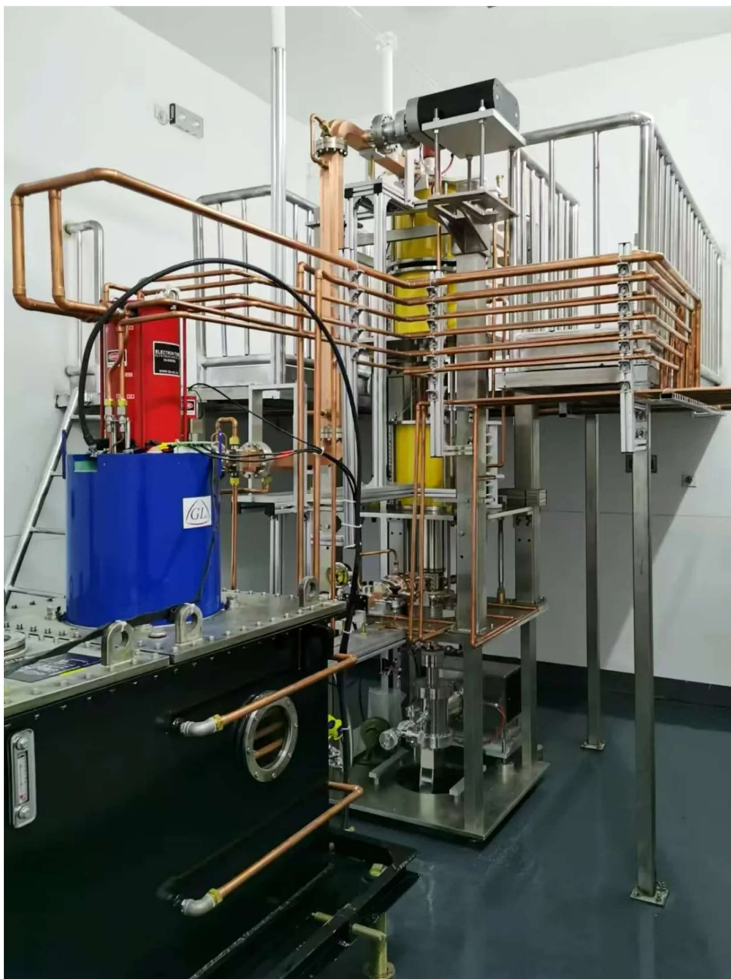
▲10MeV/20kW 直线电子加速器
